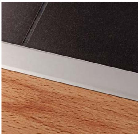
Dieses Profil dient dem Schutz der Fliesenkanten und der dauerelastischen Fugendichtungsmasse. Das Deco T-Profil wird nach dem Verlegen des Belags in den Kleber eingedrückt und gewährleistet so die Abdichtung sowie eine ästhetische Abdeckung.
